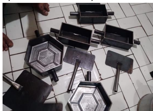
Gambar 3 Cetakan Paving Block Plastik yang Menjadi Tempat Sampah Plastik Dicetak Menjadi Paving Block yang Cantik
