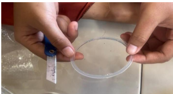
Gambar 2. Pisahkan lingkaran gelas plastik menggunakan cutter
